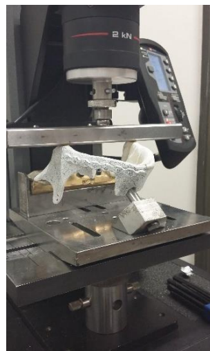
Rys.1. Sposób realizowanego podparcia symetrycznego na maszynie wytrzymałościowej Instron®5944
