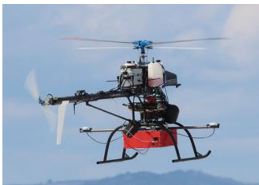
Rys. 1. System inercyjno- nawigacyjny xNAV firmy OxTS zamontowany na UAV [3]
